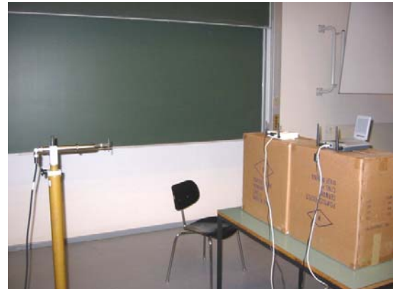
Foto 9: Parallelbetrieb von Accesspoints bisheriger und neuer Technik
